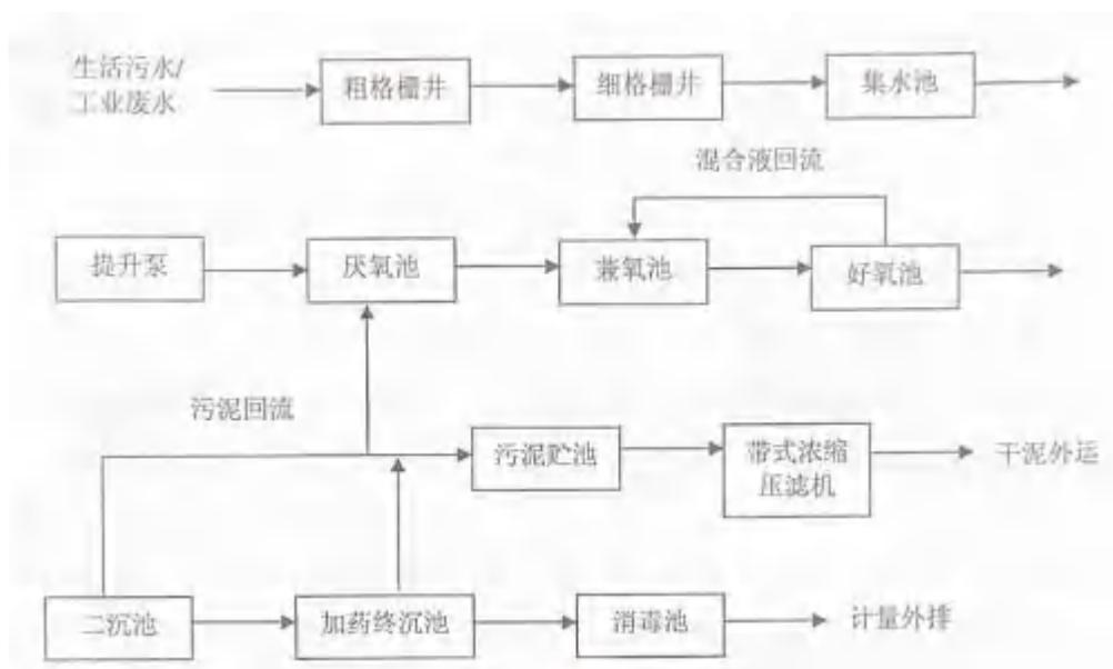
图 5.2-1 大慈岩镇污水处理厂污水处理工艺
