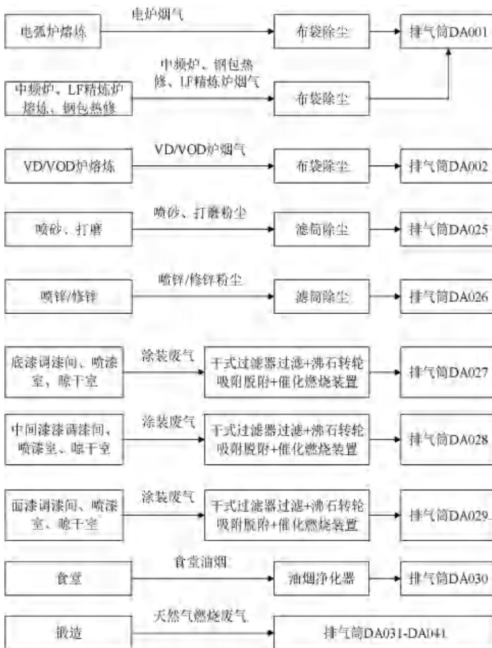
图 4.5-1 项目废气处理示意图
